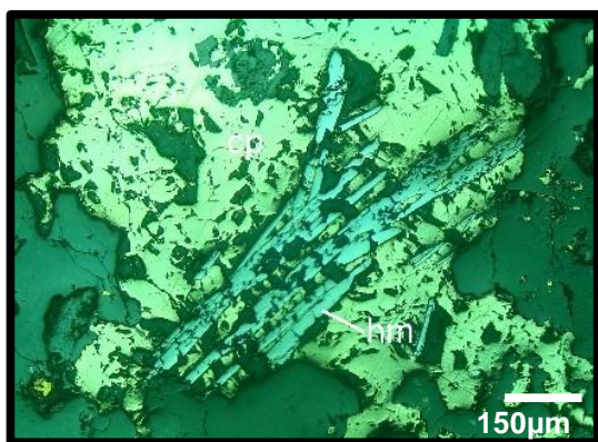
Figura 13 – Depósito Bacaba - Cristais lamelares de hematita (hm) envolvidos por massa de calcopirita (cp).
