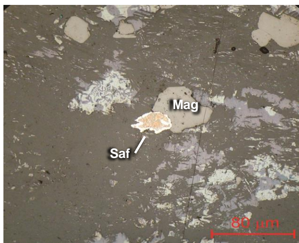
Figura 42 – SALOB 4, luz refletida – Imagem mostra magnetita (Mag) subédrica a anédrica em contato com safflorita (Saf) bem alterada.
