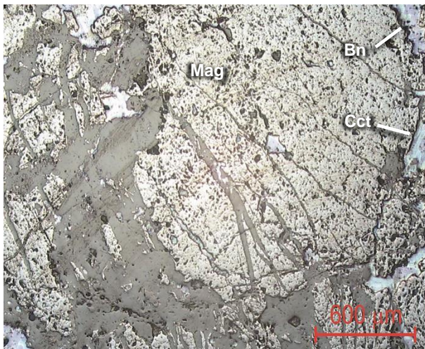
Figura 48 – SALOB 5, luz refletida – Magnetita (Mag) cortada por vênulas com os interstícios preenchidos com calcocita (Cct)
